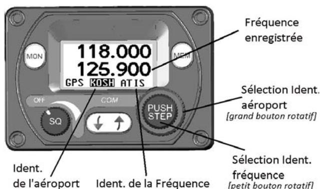
Le grand bouton rotatif de sélection des fréquences permet de parcourir les aéroports disponibles. Le petit bouton rotatif de sélection des fréquences permet de parcourir les fréquences individuelles associées à l'aéroport de votre choix. La mémoire intégrée du panneau de contrôle s'affiche lorsque vous avez fini de faire défiler tous les aéroports chargés ou s'il n'y a pas de GPS connecté.
